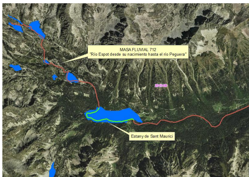
Figura 27. Discontinuidad cartográfica en el tramo superior de la masa tipo río ES091MSPF712 en el río Espot. Se propone suprimir línea aguas arriba del Estany de Sant Maurici
