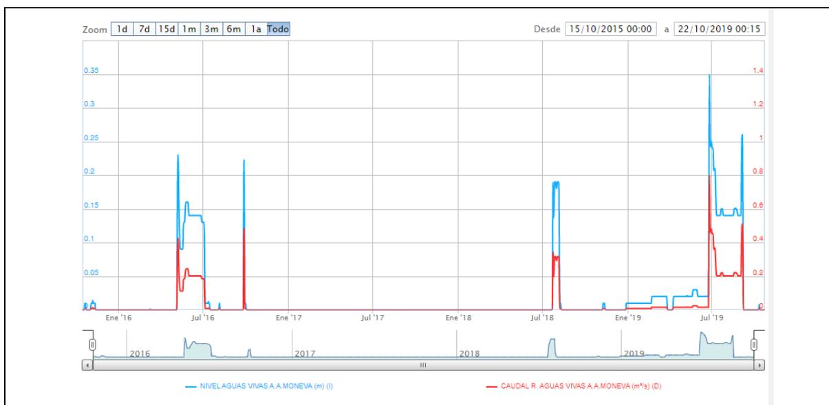
**Figura 21:** Caudales desembalsados desde Moneva medidos en la estación de aforos 9168 Moneva pie de presa (en rojo m<sup>3</sup>/s)
