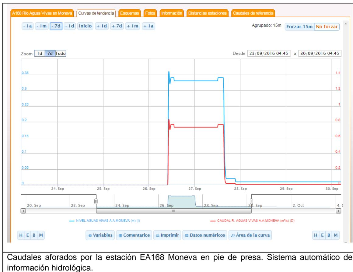
Caudales aforados por la estación EA168 Moneva en pie de presa. Sistema automático de información hidrológica.
