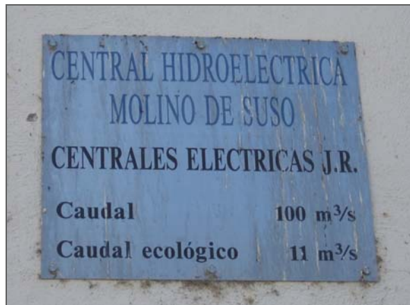
Panel informativo del caudal concesional y ecológico de la C.H. Molino de Suso
