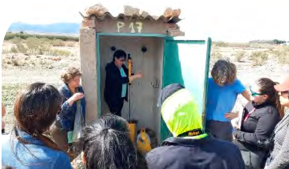
Realización de una medición manual en el piezómetro Virgen de las Lagunas en el Acuífero de Alfamén
