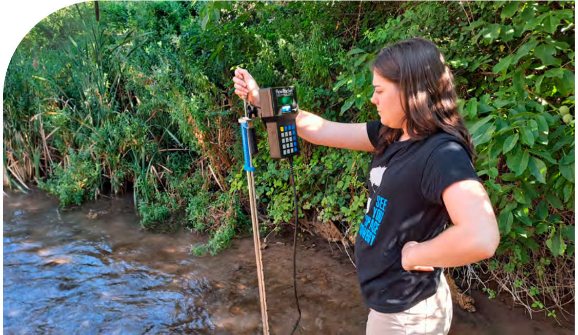
Medición de caudal con tecnología Doppler
