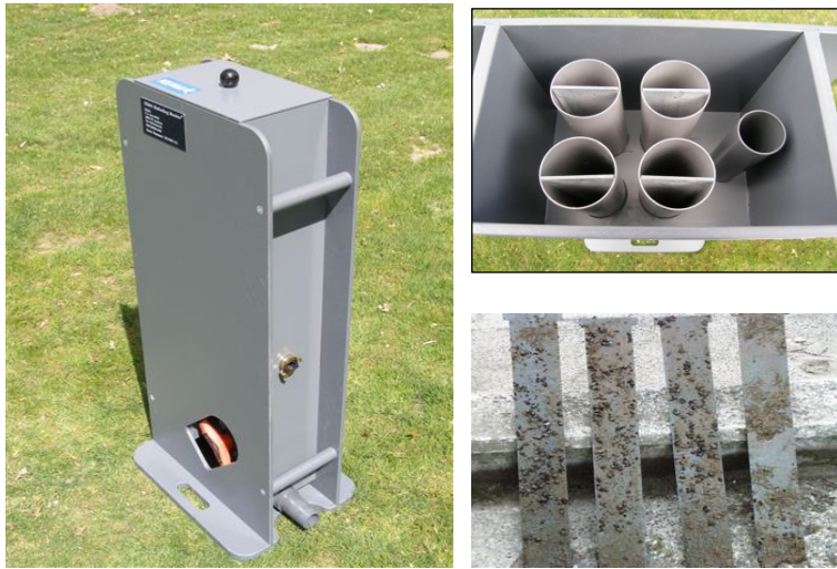
Figura 12 El KBM, vista general, visión desde arriba y placas para la contaminación, situadas dentro del monitor
