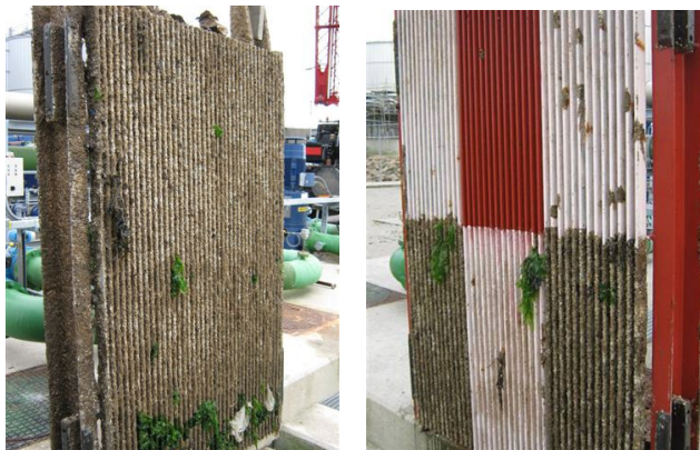
Figura 6 Prueba con diferentes recubrimientos, a la izquierda rejilla no recubierta y a la derecha rejilla recubierta
