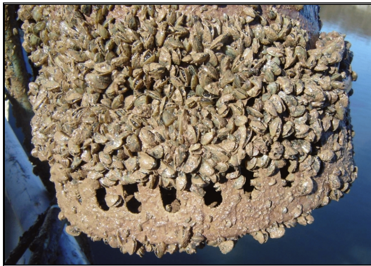
Mejillón cebra en bomba sumergida, ubicada en el río Ebro aguas arriba de Miranda de Ebro (canal de Cabriana).
