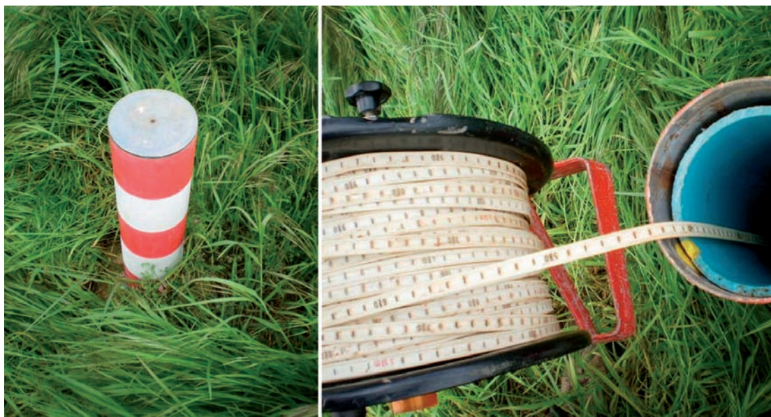
■ FIGURA 5.2.46 MUESTREO Y MEDIDA DE NIVEL PIEZOMÉTRICO EN EL PUNTO 261770164 ARROYO VILLARROYA (PO. 503; PA. 119) (TTMM MAINAR, ZARAGOZA), REALIZADO EL 22/05/2013. CONCENTRACIÓN DE \text{NO}_3^- 40,8 mg/l
